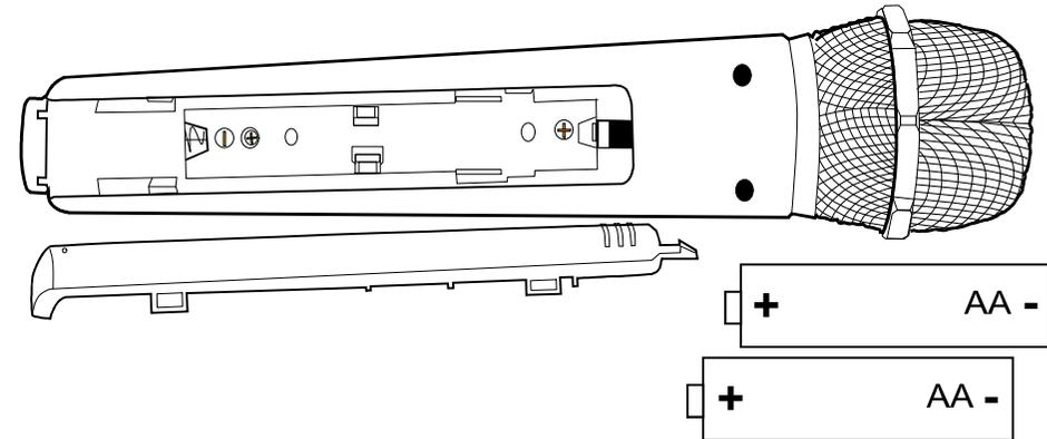
Inicialmente, coloque 2 pilhas AA 1.5V (pequena) conforme a ilustração tendo o cuidado de verificar a polaridade. Quando apresentar a necessidade de trocar as pilhas, deve-se trocar as 2 no mesmo período.
